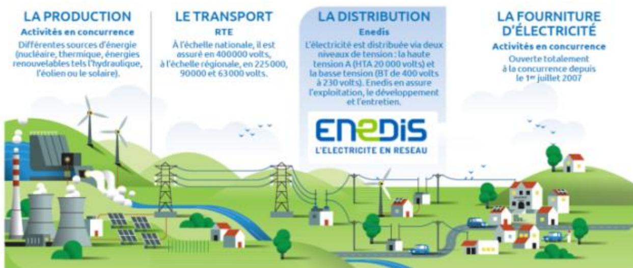
La distribution de l'électricité s'appuie sur les **réseaux Haute Tension A (HTA\*) et Basse Tension (BT\*)**.
